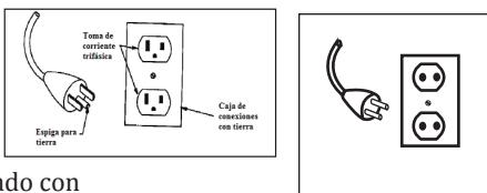
un cable y enchufe de conducción a tierra. El enchufe debe conectarse a una toma de corriente apropiada, que esté instalada y conectada a tierra de acuerdo con todos los códigos y ordenanzas locales.
